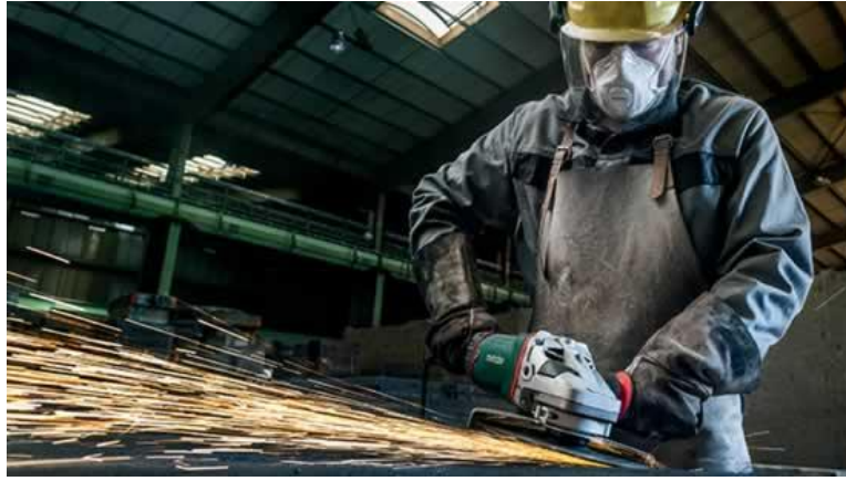
Şekil 13:TAŞLAMA SIRASINDA KIVILCIM SIÇRAMASI
